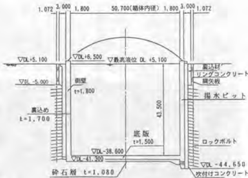
図-1 地下タンクの構造(断面)
