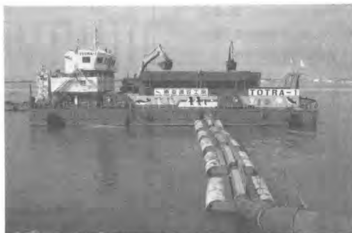
写真-1 高濃度軟泥圧送船 TOTRA-1
