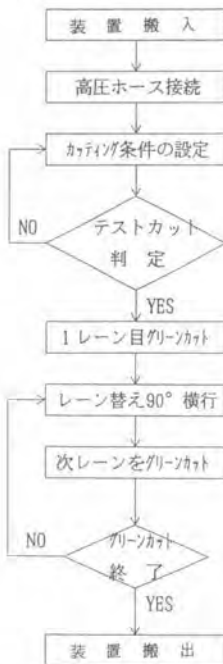
図-4 水ジェットタイプ施工手順
