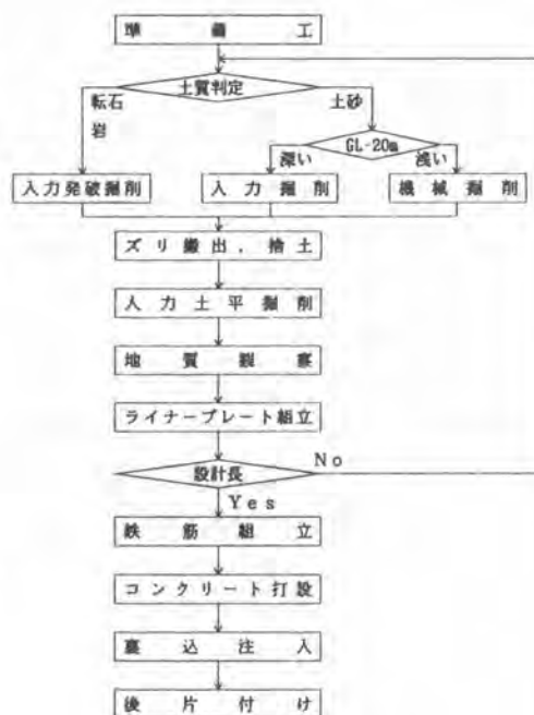
図-1 深礎作業手順
