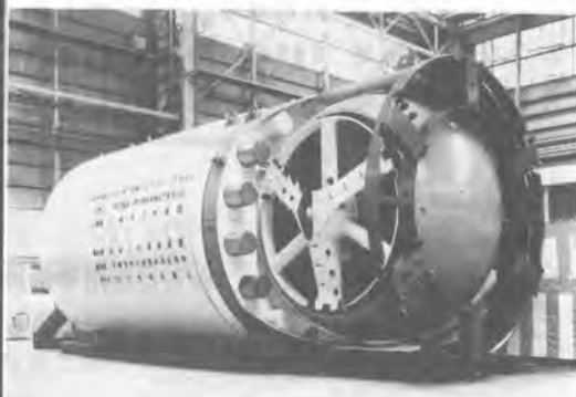
写真-2 直角シールド
