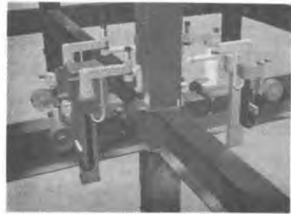
写真一3 梁用溶接ロボット
