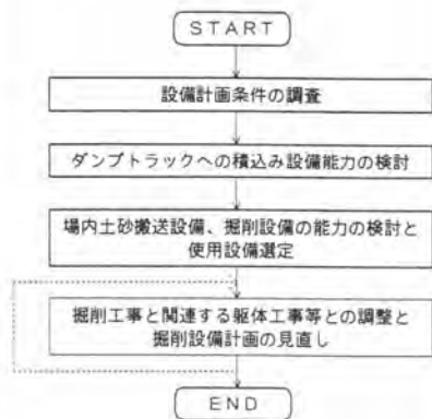
図5 掘削土搬出設備の計画手順
