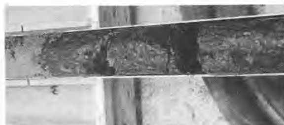
写真9 割れ目の多い黒色片岩と風化層の互層のサンプル - 地層の変化が明確に確認できる
