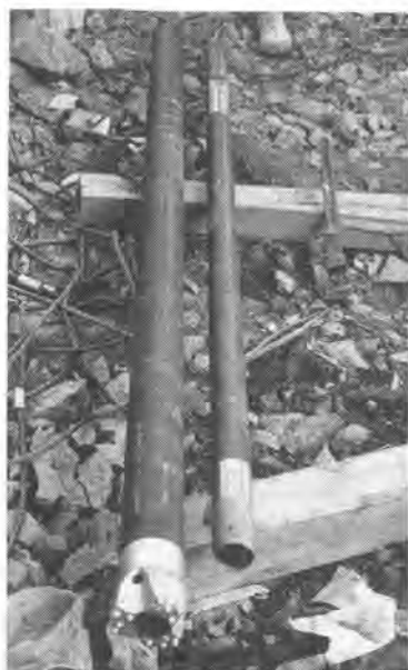
写真3 アウトチューブ（左側） インナチューブ（右側） コアビット（アウトチューブ先端）
