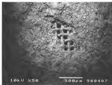
写真-5 金網の目詰まり状況
