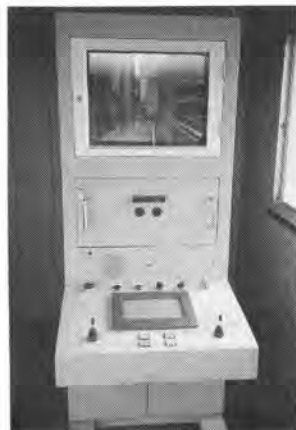
写真-4 クレーン操作盤（右側：立体視モニタ）
