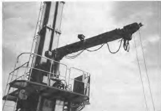
写真-3 ブームに設置した立体視カメラ
