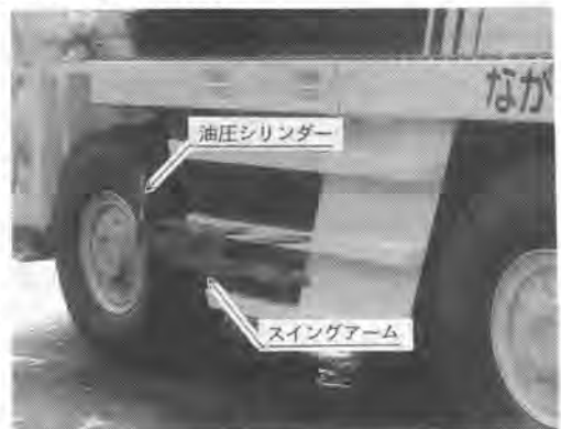
写真-4 ハイドロ・ニューマチック・サスペンションの構造
