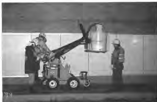
写真-2 清掃試験状況(トンネル内)
