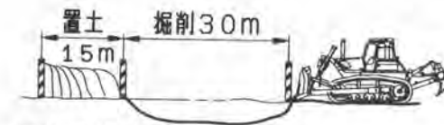
掘削押土時の速度段選定
