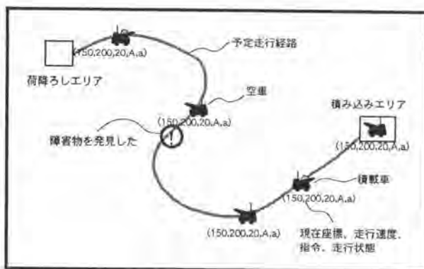
図-3 コントロールセンターモニター画面
