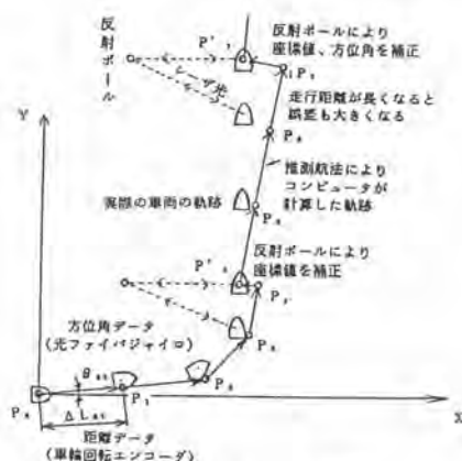
図-6 位置計測補正原理
