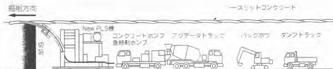
図-8 スリットコンクリート施工図
