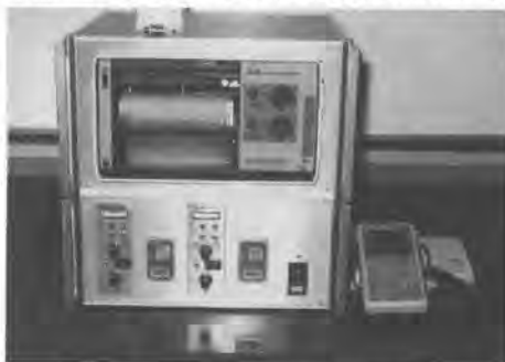
写真-4 振動レベル測定システム
