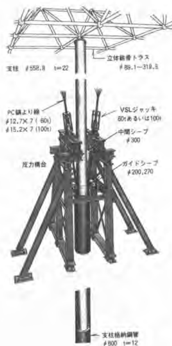
図-5 プッシュアップ装置概要
