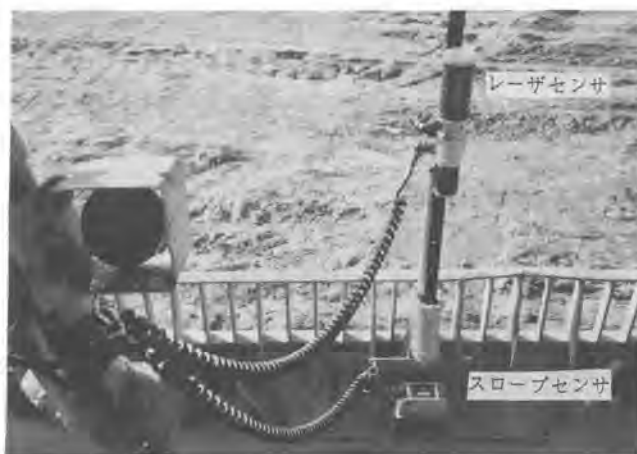
写真-2 遠隔操作式ブルドーザ部
