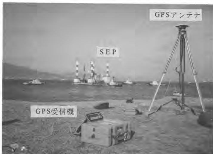
写真-2 GPSによるSEP誘導状況
