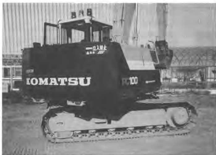
写真1 接触防止型油圧ショベル外観
