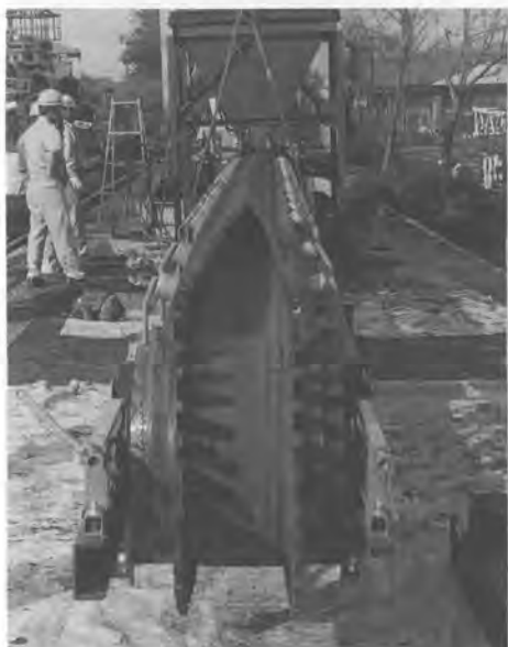
写真4-2 急傾斜ベルトコンベアの正面
