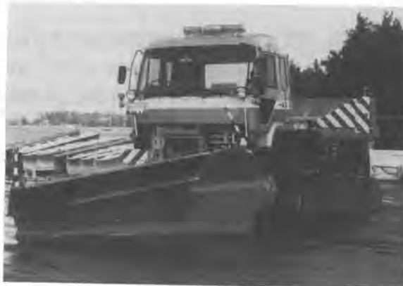
写真-2 新型除雪トラックの全景
