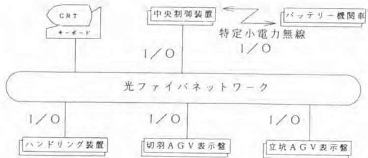
図1.セグメント搬送システム(2号新淀川共同溝シールド)
