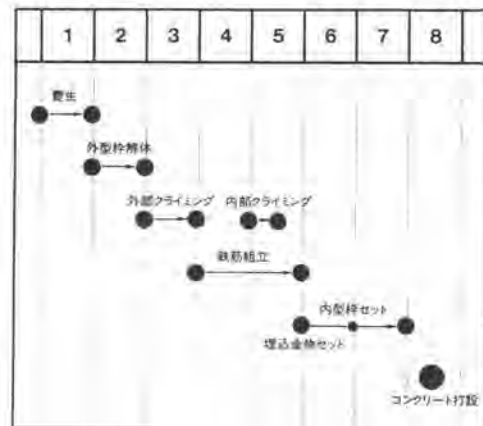
図-9 施工サイクル
