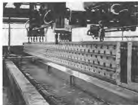
図8 超音波洗浄槽およびアルミ板の洗浄状況
