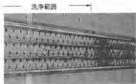
図5 超音波洗浄による洗浄状態
