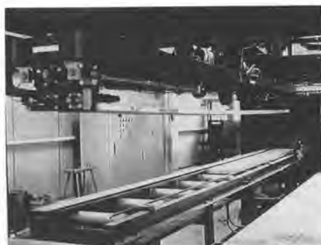
図9 自動搬送システム
