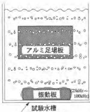
図3 超音波洗浄の実験装置概要
