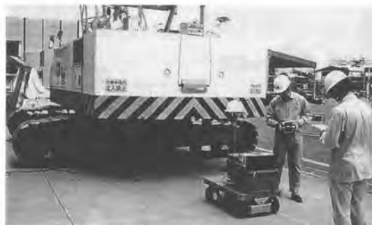
写真—3 電界強度計測状況
