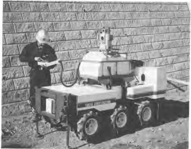
写真-1 測量ロボット
