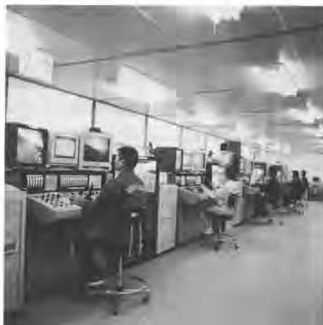
写真-2 中央管理室における掘削状況
