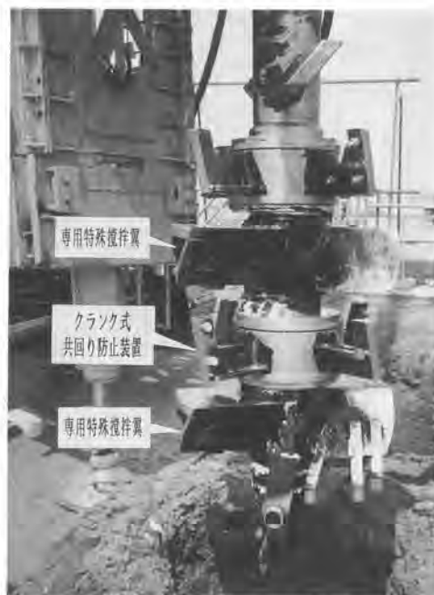
写真-2 クランク式共回り防止装置
