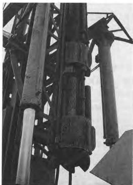
写真-2.1 ロッド先端吸水機構
