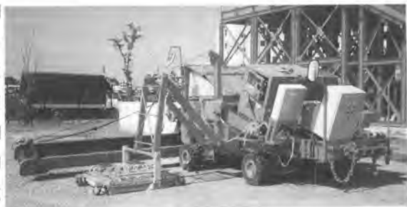
写真-2 斜面用合材運搬車外観
