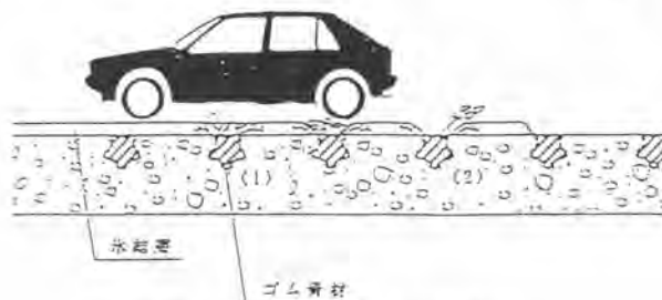
図-2 凍結抑制のメカニズム
