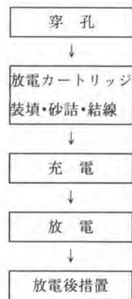
図8 放電破碎作業フロー
