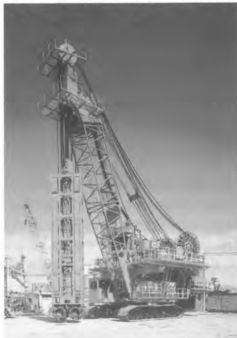
写真-1 都市型連壁ハイドロフリーズHFA-4型
