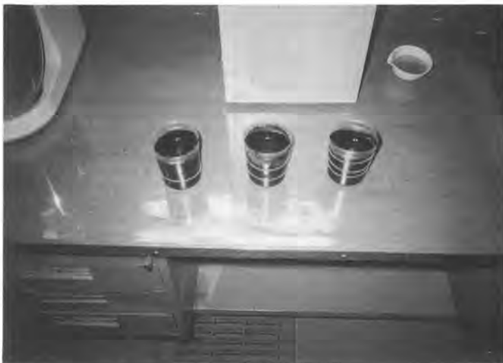
写真-3 沈殿槽に捕捉したスラッジ
