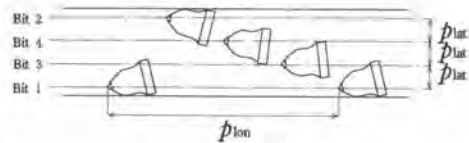
図-4 切削ドラム、切削溝図
