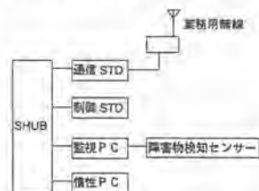
図4-2-1. 1 自律走行のシステム構成
