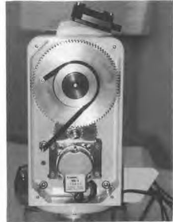
写真-5 経緯台の駆動機構
