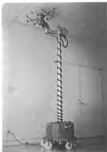
写真5 パーソナル内装施工ロボット
