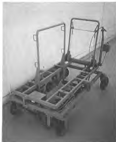
写真2 電動式搬送装置
