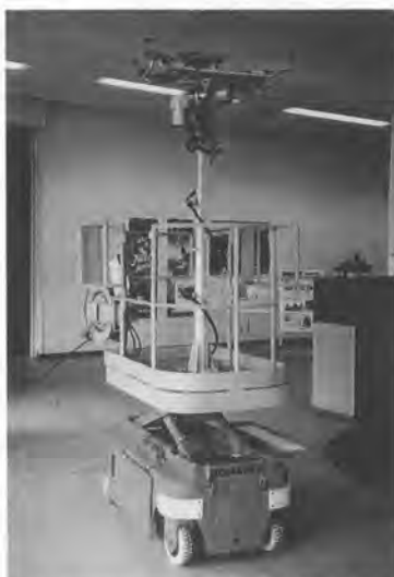
写真6 自走式内装施工ロボット
