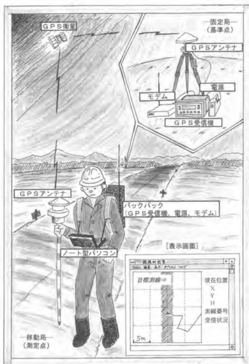
図-2 縦断・横断測量の概要
