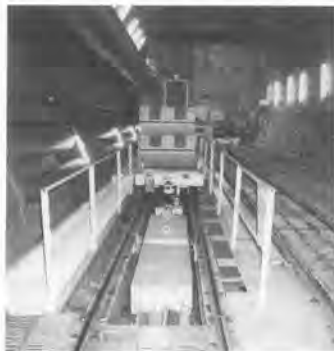
写真-5. ドーリ台車
