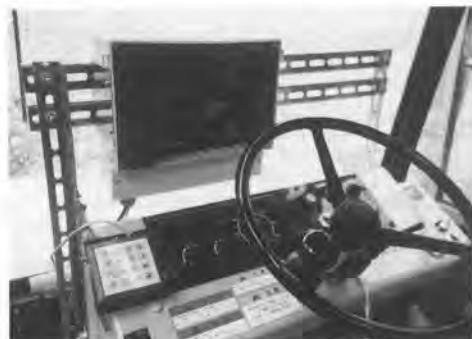
写真-3 振動ローラーの運転席状況
