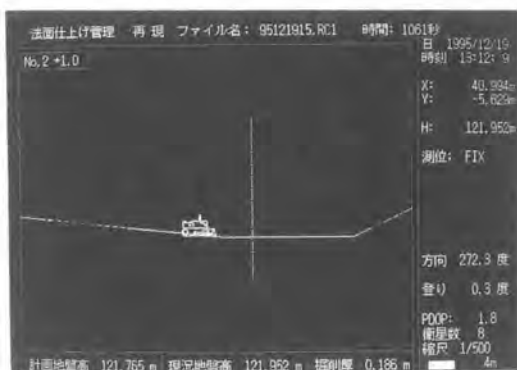
写真-5 法面仕上げ管理モニター画面
