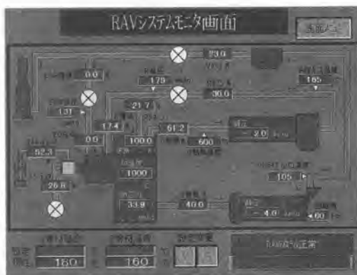
写真-6 操作盤モニター画面
