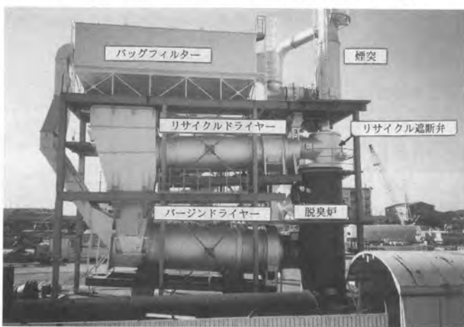
写真-2 RAVコンビネーションシステム全景
