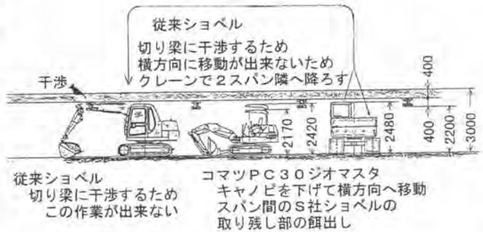
図11. 当初計画 従来ショベルとコマツPC30の共同作業
