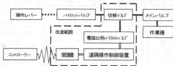
図-2 油圧パイロット方式の改造概念図
