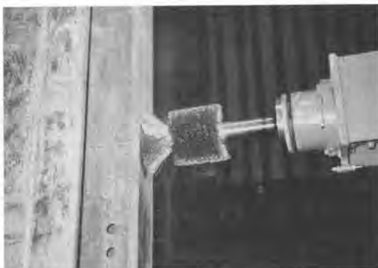
写真-3 外面用回転ワイヤブラシ (稼動状況)
