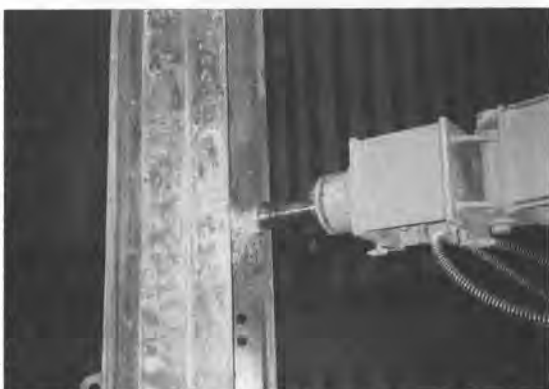
写真-4 内面用回転ワイヤブラシ (稼動状況)
