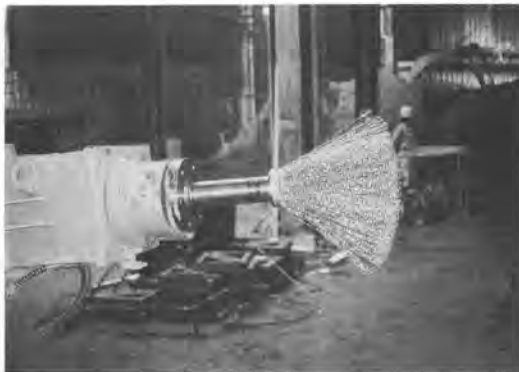
写真-5 遠心拡張型ワイヤブラシ (停止状態)
