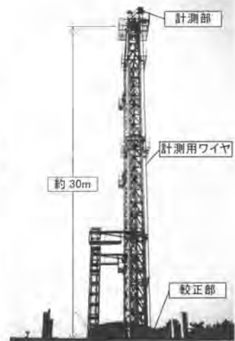
写真-1 屋外気中実験
