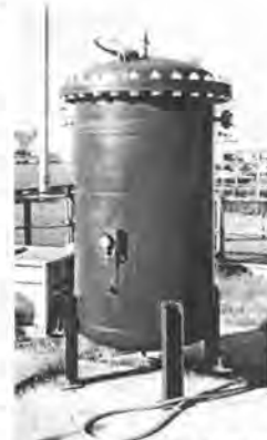
写真－3 耐圧試験容器
