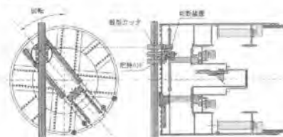
図-7 切断開始状況
