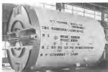
図一1 ドレーン材切断装置付シールド機
